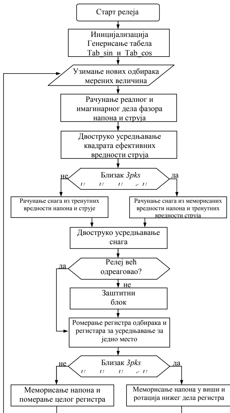
Слика 1. Алгоритам усмерене функције заштите MPZ-ZIM
